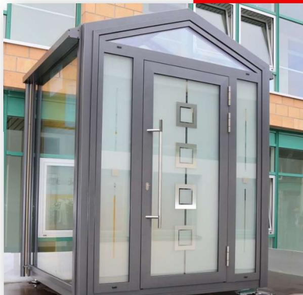
Der Firstpunkt wurde mit Ganzglasecken geplant und gefertigt, sodass der darunter liegende Raum maximal mit Licht durchflutet werden kann. Dank des Dreifach-Isolierglases kommt das Haustürelement des Windfangs auf einen U-Wert von  $1,6 \text{ W/m}^2\text{K}$ .
